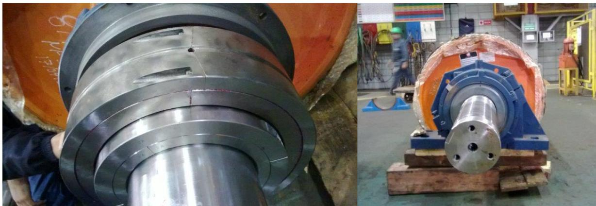
O primeiro rolamento foi instalado em 06/2013 e ao ser removido em 08/2014 devido a problemas com o redutor percebeu-se mínimo desgaste. Hoje esse TC continua com o rolamento IBROL e opera satisfatoriamente.
